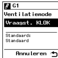
Vraagsturing Klok (commande demande Horloge)
