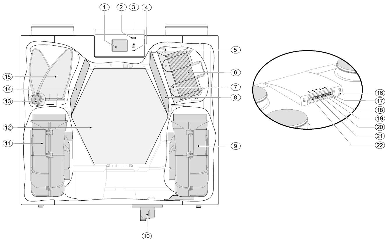
L'appareil illustré ci-dessus est une version gauche ; pour une version droite, le raccordement du préchauffage, la soupape de bypass et le raccordement du siphon sont installés en miroir !
