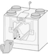
7. Faites tourner le ventilateur d'un quart de tour dans l'appareil.
