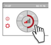
En appuyant sur l'un des quarts de cercle de l'écran principal, le mode de ventilation peut être rapidement réglé. Le mode de ventilation ainsi réglé reste actif pendant une demi-heure, ce qui est visible sur l'affichage par une aiguille avec une horloge.
