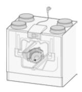
8. Pivotez le ventilateur de manière à ce au'il puisse être retiré de l'ensemble EPS ; débranchez les deux câbles du ventilateur.
