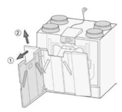
4. Retirez l'échangeur de chaleur. Veillez à ne pas endommager les pièces en mousse de l'appareil.
