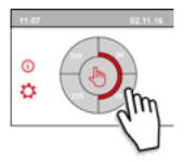
L'écran tactile peut également être réglé de façon permanente comme commutateur multiple ; pour ce faire, le n° 15.8 dans le menu des réglages doit être réglé sur « oui ».
