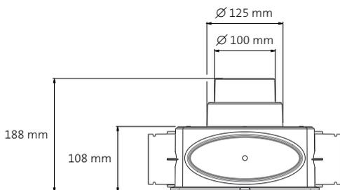
DB206 avec adaptateur multiple Ø 100 - 125 mm
