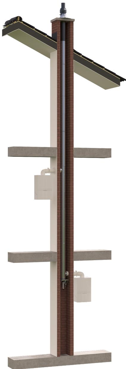
Le système d'évacuation de fumées Rolux CLV PP/Galva est un système collectif concentrique avec un conduit intérieur en PP pour l'évacuation des fumées et un conduit extérieur en acier galvanisé pour l'amenée d'air. Le système est exclusivement destiné aux chaudières gaz à condensation et adapté pour les appartements. C'est également une bonne solution pour les rénovations où la cheminée existante n'est plus adaptée à l'air de combustion.
