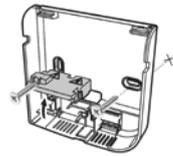
2. Posizionare il guscio posteriore del dispositivo.
