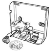
4. Collegare i cavi di alimentazione al morsetto e riposizionare la protezione.
