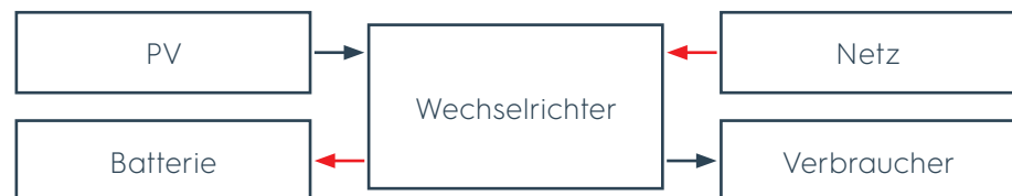
Bild 31 Solarenergie nicht ausreichend, zusätzliche Energie für Verbraucher aus dem Netz
