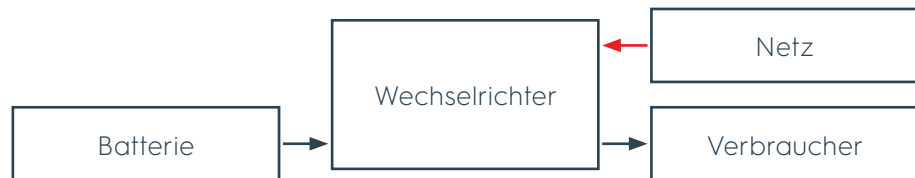
Bild 29 Energie aus der Batterie nicht ausreichend, zusätzliche Energie aus dem Netz
