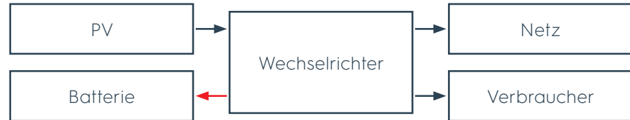
Bild 30 Solarenergie ausreichend, überschüssige Energie für Verbraucher und ins Netz
