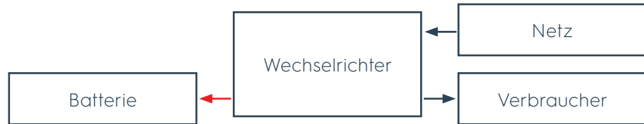
Bild 27 Energie für Batterieladung aus dem Netz
