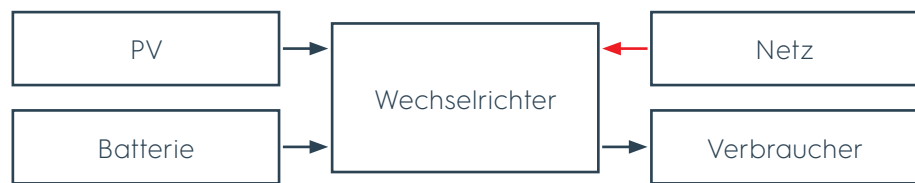
Bild 21 Solarenergie und Batterie nicht ausreichend, zusätzliche Energie aus dem Netz
