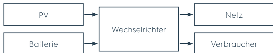
Bild 26 Batterie geladen, Solarenergie ausreichend, überschüssige Energie und Energie aus der Batterie ins Netz
