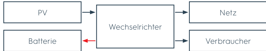
Bild 24 Solarenergie ausreichend, überschüssige Energie für Verbraucher und ins Netz
