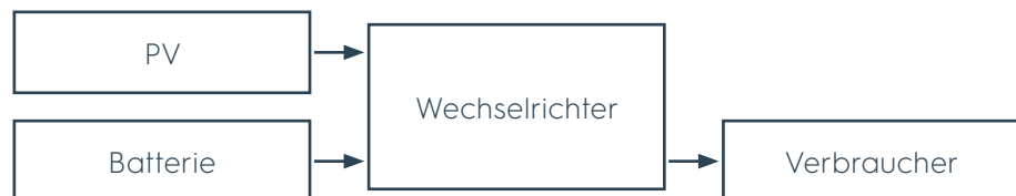
Bild 23 Solarenergie nicht ausreichend, zusätzliche Energie aus der Batterie
