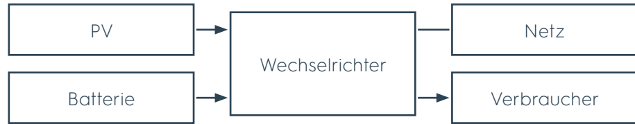
Bild 20 Solarenergie nicht ausreichend, zusätzliche Energie aus der Batterie
