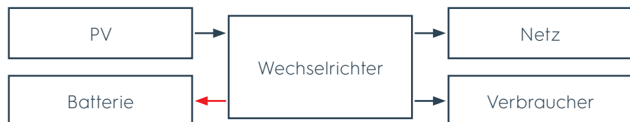
Bild 19 Solarenergie ausreichend, überschüssige Energie für Batterieladung und ins Netz
