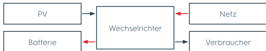
Bild 25 Solarenergie nicht ausreichend, zusätzliche Energie für Verbraucher aus dem Netz
